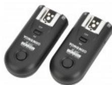
Transmetteur bidirectionnels full duplex fonctionnant avec un protocole standard FSK 2.4Ghz. Le signal de sortie est l'image de l'entrée avec un minima (Voir document RF603 pour plus de détails).
